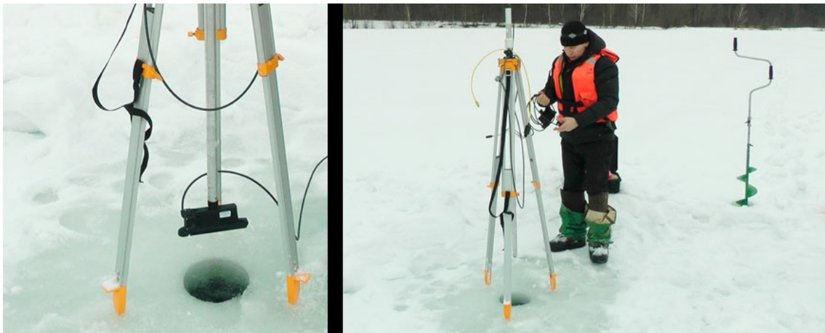
Рисунок М.1. Установка ГБО на SSU003 и работа со льда
