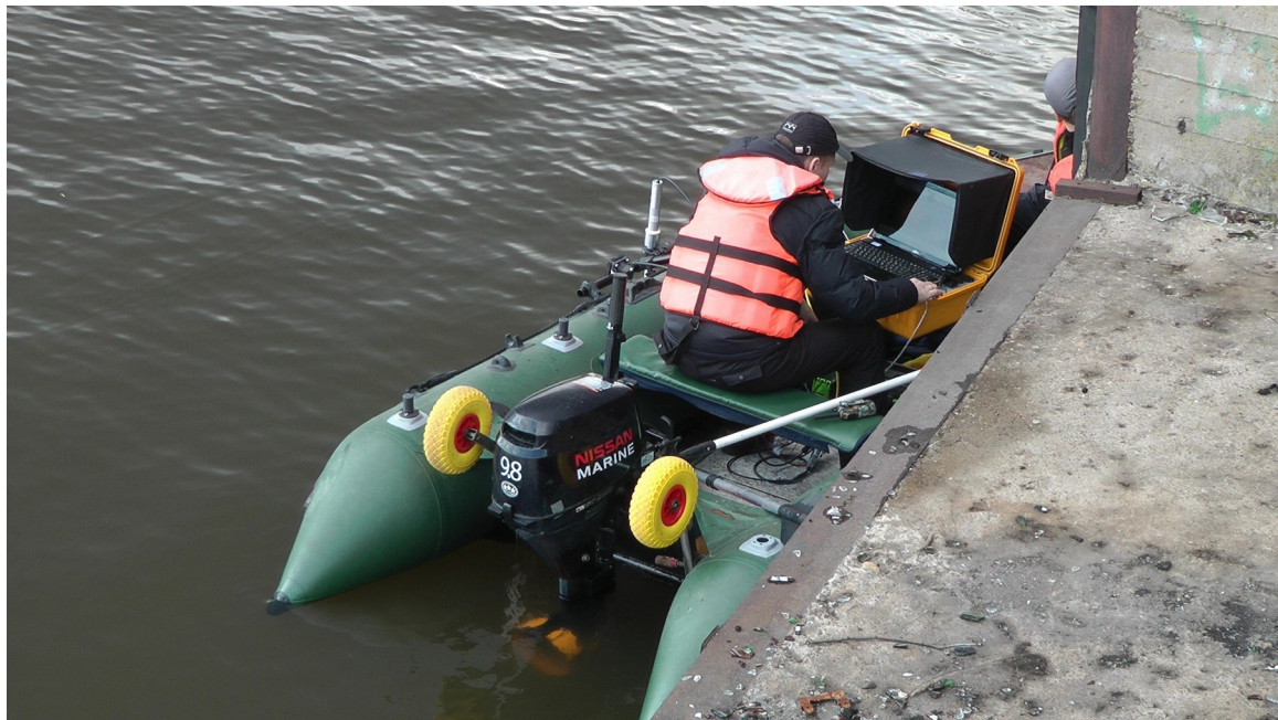
Рисунок М.3. Установка ГБО на SSU003 и работа с лодки (привод с ГБО установлен на левый борт)
