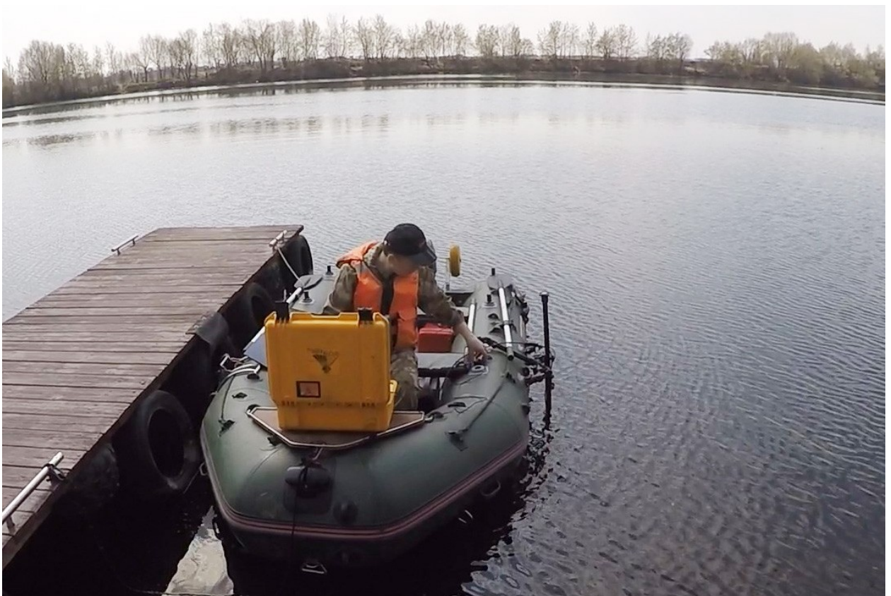
Рисунок К.1. Крепление ГБО на надувную лодку с помощью КИТ006
