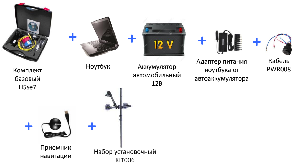
Рисунок 9. Вариант 1 комплекса для работы на надувной лодке
